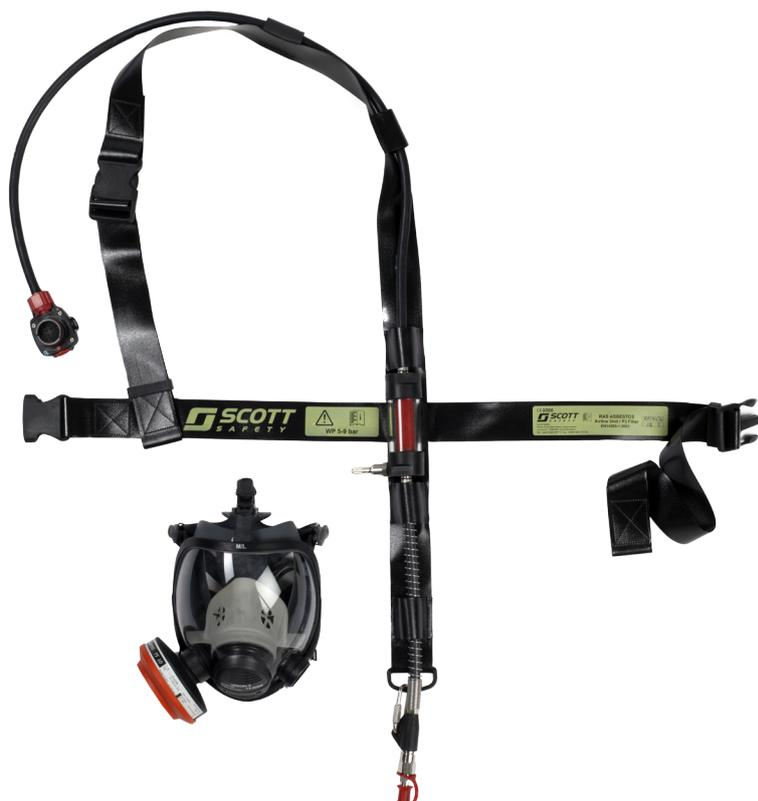
L'appareil de protection respiratoire à adduction d'air RAS Amiante est un appareil à pression positive qui apporte les niveaux les plus élevés de protection respiratoire. La soupape à la demande Tempest fournit une pression positive à l'intérieur du masque, ce qui permet de lui attribuer un facteur de protection de 2000 et en fait l'appareil idéal pour une utilisation dans des zones très contaminées.
